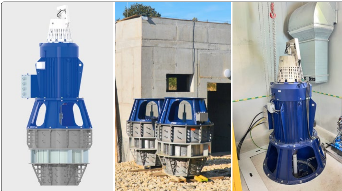
Fot. 3. Turbina Kaplana na różnych etapach – projektowania, tuż przed montażem i wewnątrz budynku MEW po zamontowaniu
