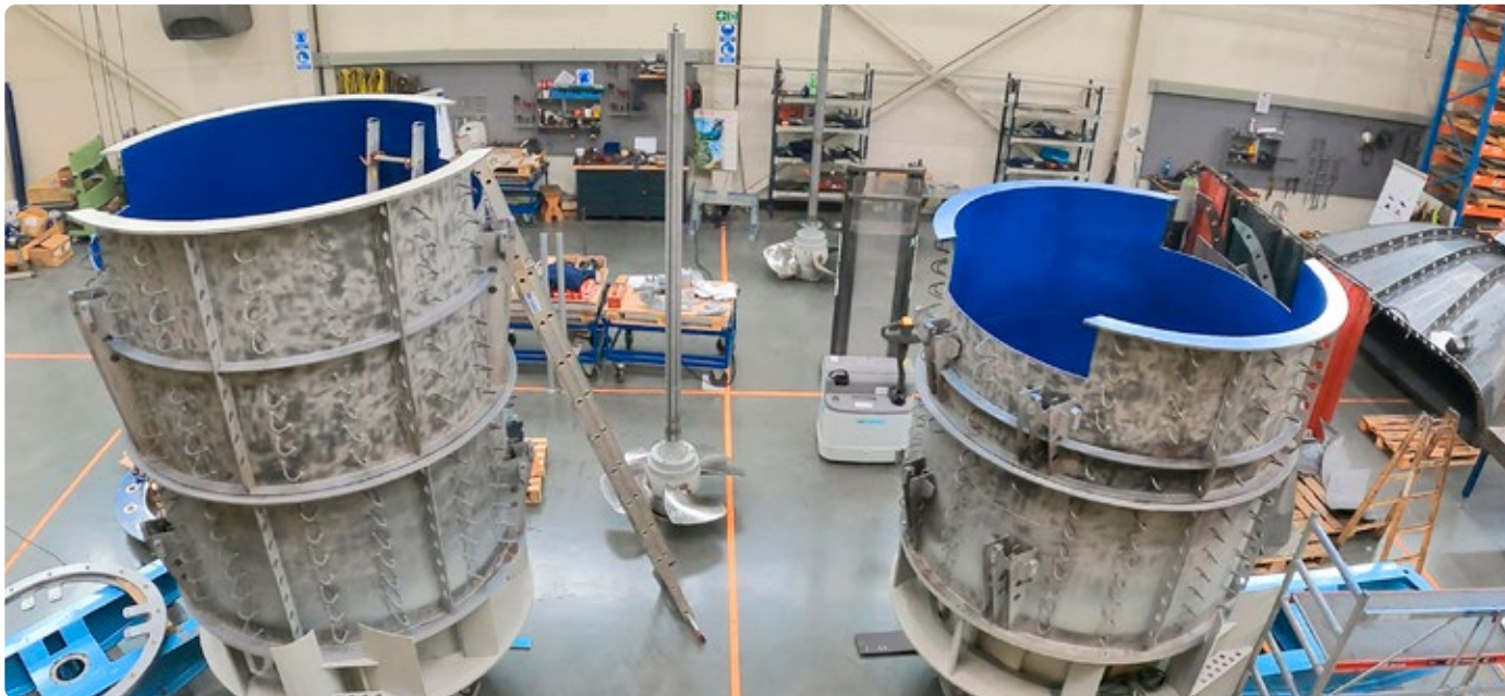
Fot. 4. Montaż nowych turbin w hali produkcyjnej
